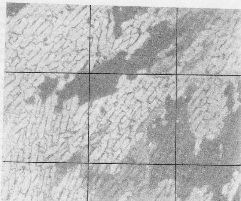
Рис. 1. Микрофотография поперечного среза кристаллитов морского льда [по Weeks, Hamilton, 1962]
